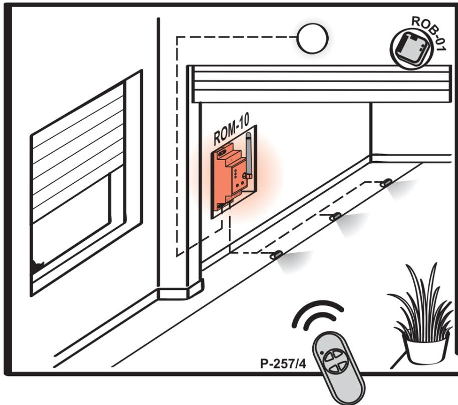
Модульный радиоприемник ROM-10, работающий в качестве приемника четырехканального пульта управления P-257/4 (управление освещением перед и в гараже). Дополнительно, пульт управления P-257/4 может управлять работой радиоприемника ворот ROB-01/12-24V.
