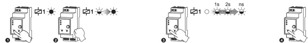
Нажать кнопку PROG 1 устройства ROM-10 и придержать ее до загорания (постоянный сигнал) красного диода LED. После отпустить кнопку PROG 1. Подождать (около 5 с) пока диод LED зажжется (мигающий сигнал, а потом постоянный).
