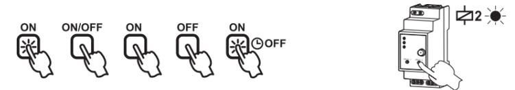
Выбрать один из пяти режимов работы ROM-10 и запрограммировать устройство аналогично как для канала 1, причем следует нажимать кнопку PROG 2 и следить за диодом LED для 2 канала.
